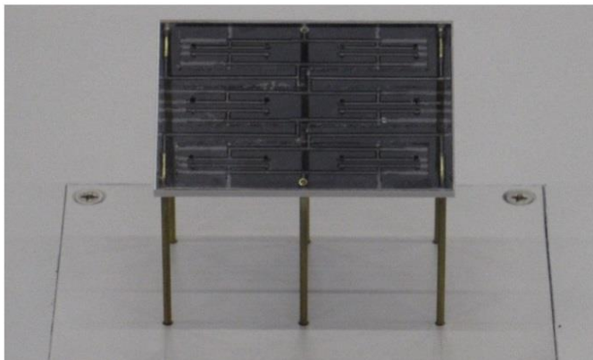
図3-2 パネル単体の風圧計測孔と風圧計測chの概要
